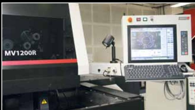
Beim Erodieren ist der Bediener nur gefordert, zwischen den Prozessen zu definierten Zeiten die Ausfallteile zu entnehmen. So lässt sich Mehrmaschinenbedienung effizient gestalten, und die Anlagen werden optimal ausgelastet.
